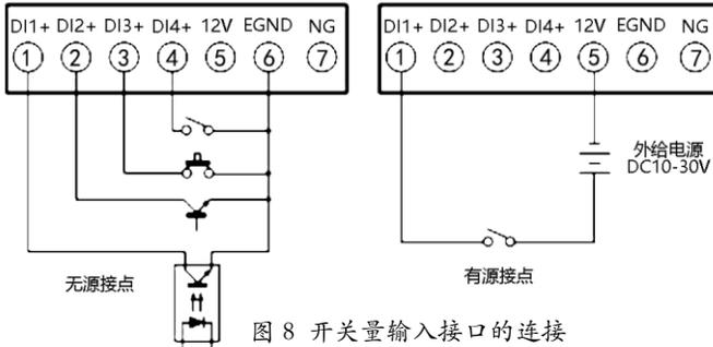
图 8 开关量输入接口的连接
