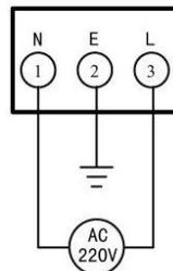
图 20 电源的连接
