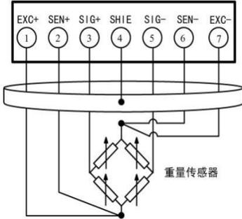
图 10 六线制重量传感器时的连接
