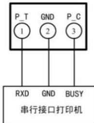
图 19 打印机接口的连接
