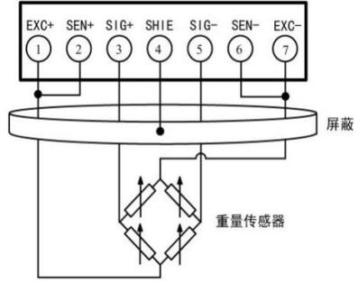
图 11 四线制重量传感器时的连接
