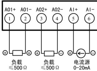
图 7 模拟量输入输出接口的连接
