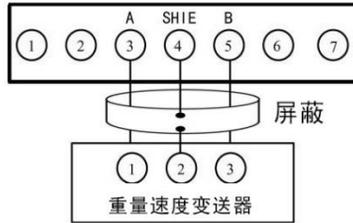
图 12 数字传输方式时的连接
