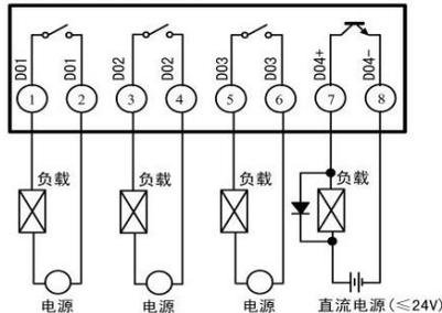
图 9 开关量输出接口的连接
